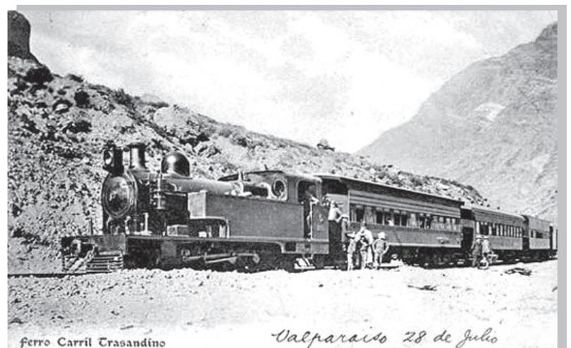
*Locomotoras Kitson-Meyer y Esslingen, dotadas de engranajes para el funcionamiento de las cremalleras. Esta imagen corresponde a la localidad de Portillo (julio del año 1911).*
