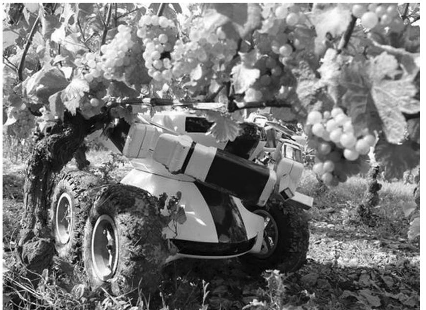
El proyecto VineRobot, un robot autónomo creado en Francia. Su inventor creó un equipo que realiza la cosecha mecánicamente y mide tamaños de los racimos del viñedo en tiempo real para facilitar la toma de decisiones. Próximamente se iniciará la fase de comercialización de este robot.
