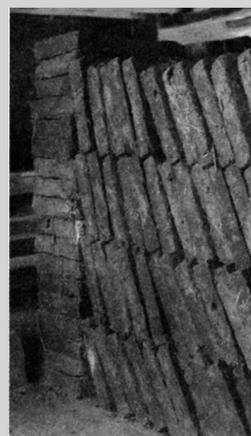
Los panes de adobe deben fabricarse con tierra de pie de monte que es arcillosa. La tierra vegetal de potrero no sirve. La diferencia entre ambas se aprecia en el color: la primera es rojiza, en cambio la otra de un tono café oscuro, casi negro. El buen adobe, el que se hace dejando podrir la paja con la greda, es firme como una piedra.
